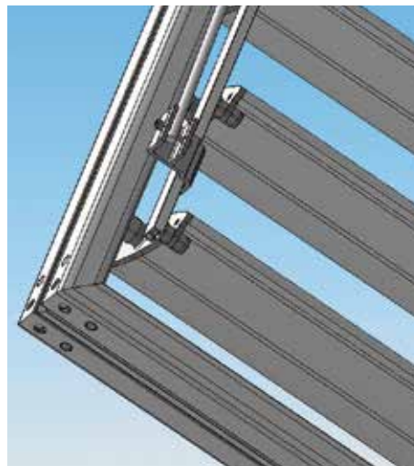
Schema di montaggio della forcella di collegamento Assembly diagram of the connection fork
